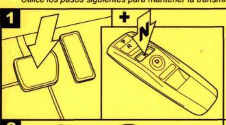
With the engine running, press and hold the brake, then push the "N" button. Con el motor en marcha, mantenga presionado el pedal de freno, luego empuje el botón "N".
